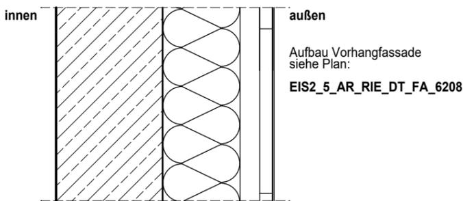
**WA 22** Wandaufbau Pfosten-Riegel Fassade
