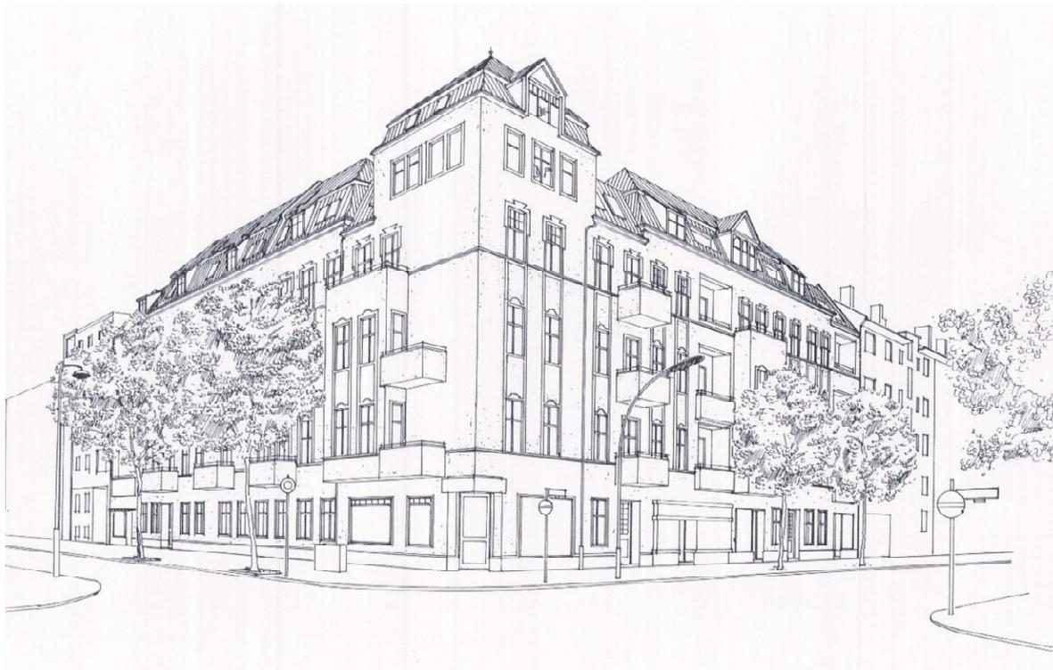
Die Außenwände erhalten ein vollmineralisches Wärmedämmverbundsystem aus Steinwollämmplatten und silikatischem Oberputz. Bis zur Höhe der ersten Geschossdecke, wird auf beiden Straßenfassaden ein widerstandsfähiger Oberbelag aus kleinformatischer Keramik bekleidet. Die neuen Fenster- und Türelemente auf der Straßenseite Eichborndämm, erhalten eine schalldämmende Verglasung der höchsten Schutzklasse.
